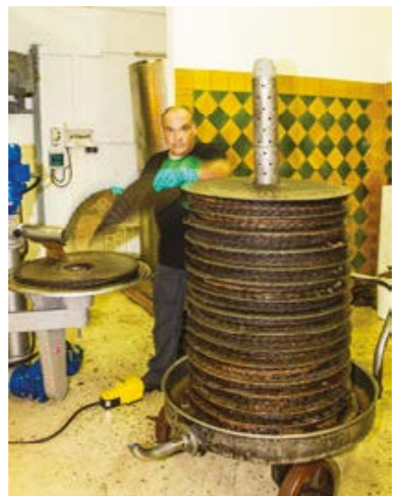
Les scourtins, une fois empilés, sont déplacés vers la presse
